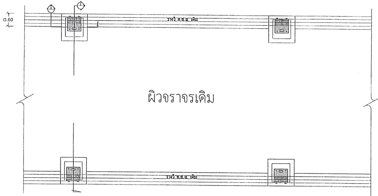
แปลนเสริมบ่อพัก ค.ส.ล.และรางไว้ในถนนค.ส.ล.เดิม มาตราส่วน 1 : 75
